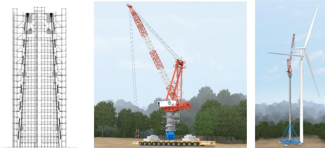
図5 VT内の足場仮設計画および S-Movable Towercrane®のイメージ図
