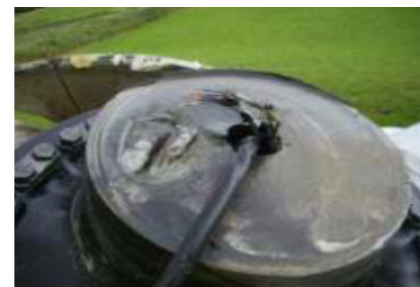
図-4 主軸破断面(ハブ側)
