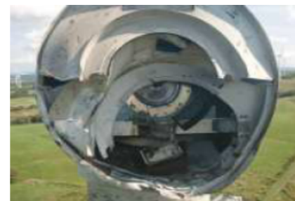
図-5 主軸破断面(ナセル側)
